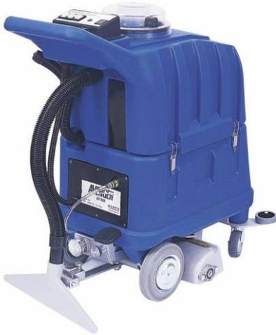
**Elite-Silent** è una lavamoquette-lavapavimenti compatta, a trazione manuale. Lava, spazzola ed asciuga una striscia di 50 cm di moquette, camminando in avanti e pulendo fino a 500mq di moquette in un'ora. Il sistema di aspirazione ad **alta depressione** consente di rimuovere la massima quantità di sporco dalla moquette e di ottenere un tempo di asciugatura molto breve.
